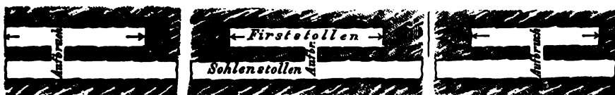
Fig. 11. Längsschnitt durch einen im Ausbruch befindlichen Tunnel.
