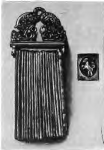
Fig. 1. Nat. Gr. H. 7 cm. Neunzehnteilige Probiernadel für Silber, mit dem Berliner Beschauzeichen von etwa 1748 bis 1778. Sammlung des Verfassers.
