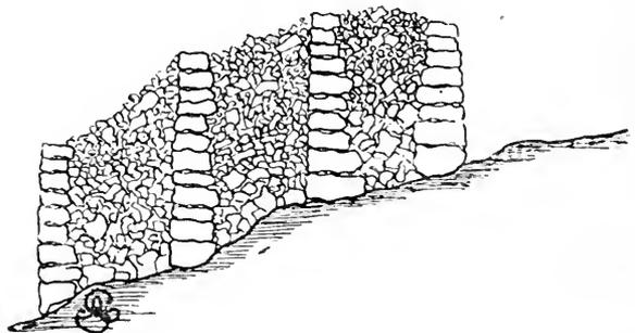
Fig. 2. — Coupe schématique d'un mur triplé.
